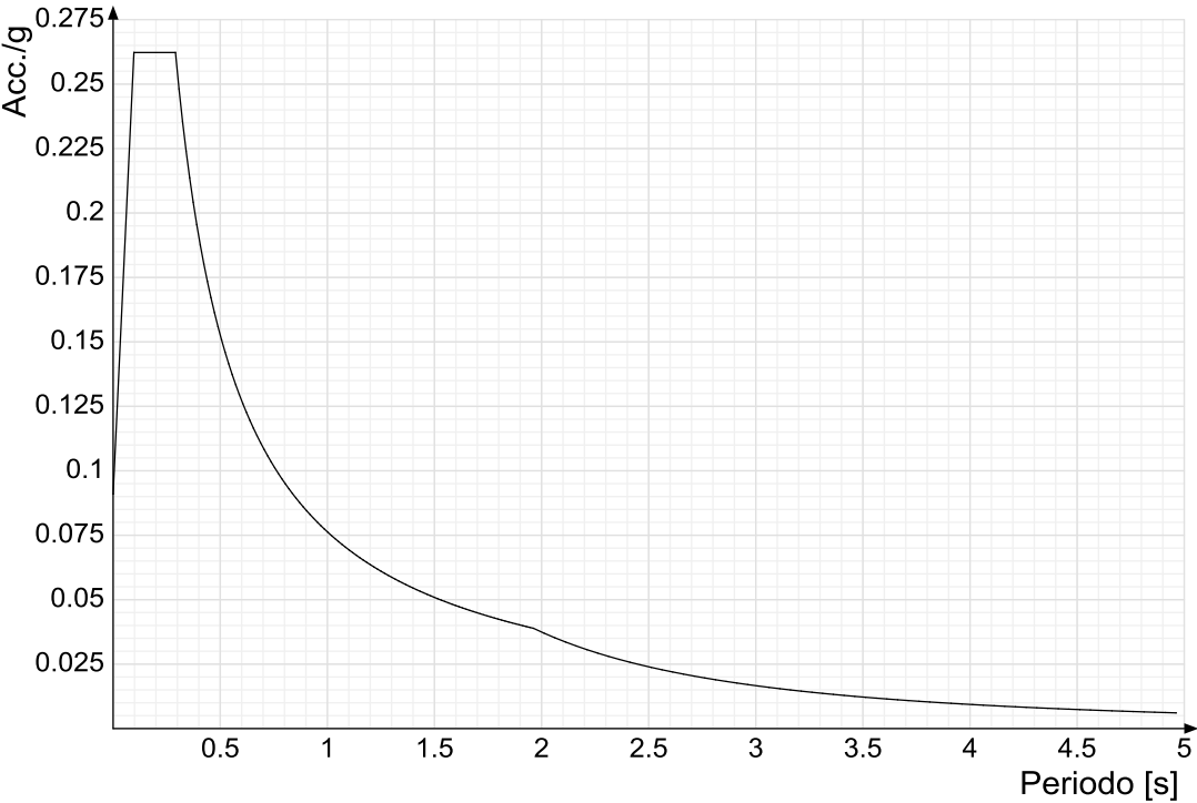
Spettro di risposta elastico in accelerazione delle componenti orizzontali SLO § 3.2.3.2.1 [3.2.2]
