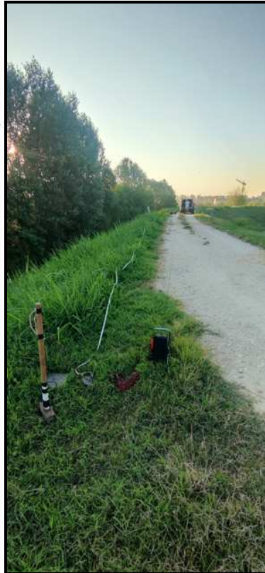
Fig. n.21 - Prova Masw1 argine Sud.
