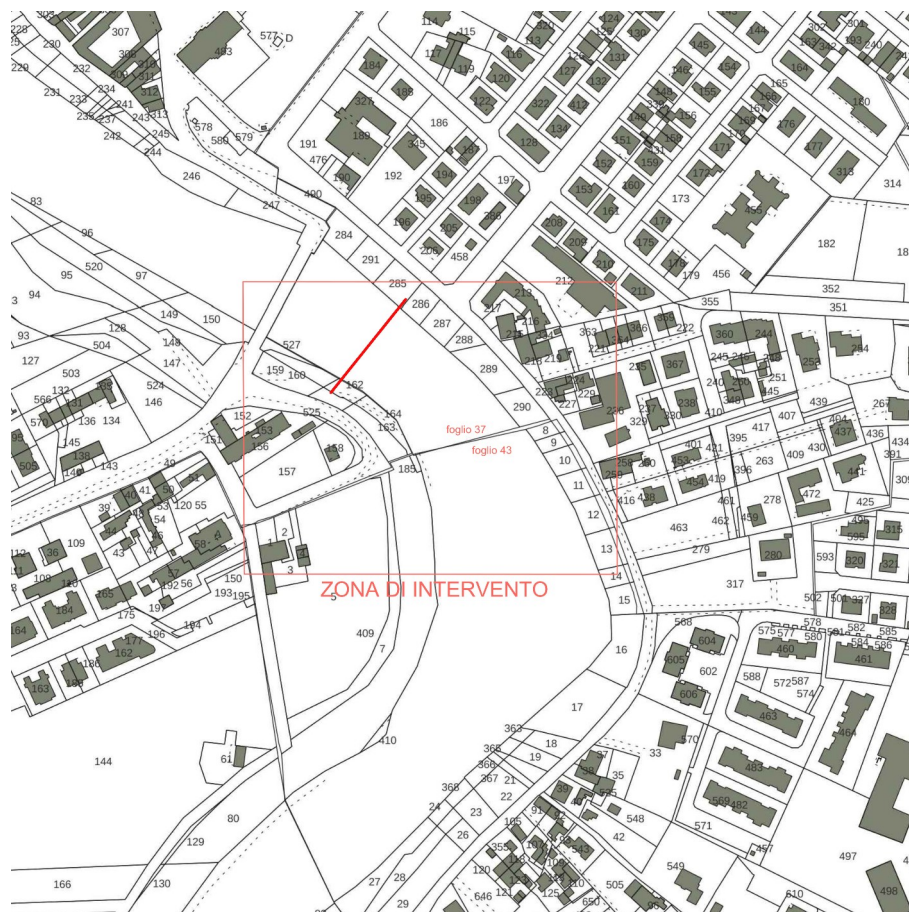
Figura 3: Estratto catastale con indicazione dell'attraversamento (in rosso)
