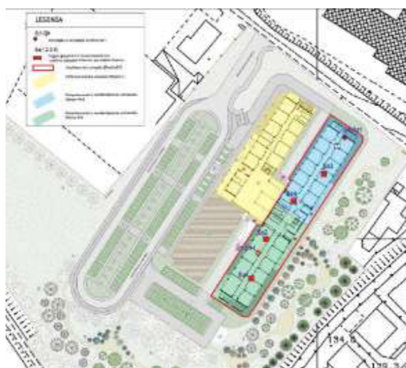
Img. 4.5.5.46 - Ubicazione dei sondaggi ambientali effettuati su foto aerea AGEA2011 (Fonte: Relazione tecnico illustrativa sulle modalità di gestione delle terre e rocce da scavo)
