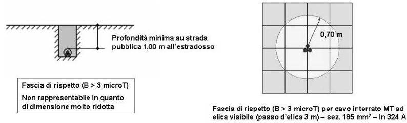
Img. 4.8.1.1.80 - Estratto Linee guida Enel Distribuzione S.p.A. relativo a linea MT interrata in cavo cordato a elica
