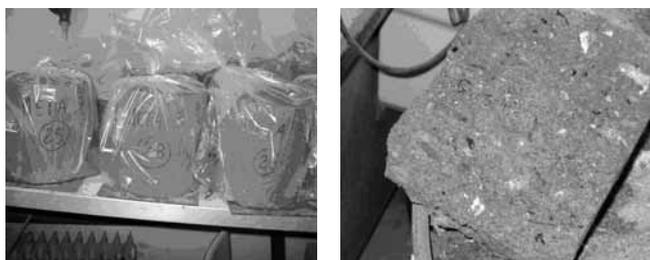
Nella foto si evidenzia la rottura quasi perfetta lungo una direttrice del cilindro di uno dei provini sottoposti alla prova di resistenza a trazione indiretta RTI.
