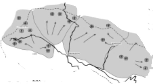
Fig. 3 - Carta delle aree di possibile alimentazione delle sorgenti censite nella zona di Serramazzone. Legenda: 1) sorgenti singole; 2) gruppo di sorgenti; 3) direzione principale di alimentazione dei bacini di raccolta; 4) area di alimentazione di una o più sorgenti; 5) limite della "placca" di Serramazzone; 6) maggiori vie di comunicazioni
