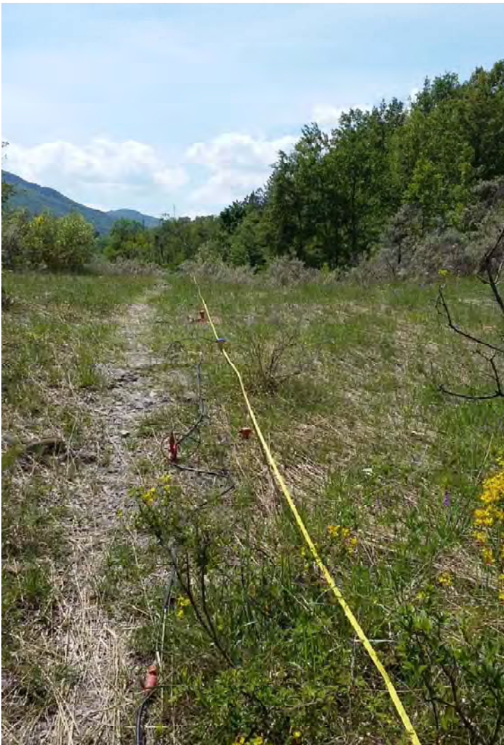
Foto n° 4 Vista da nord verso sud. Indagine geognostica: sismica tipo Masw.
