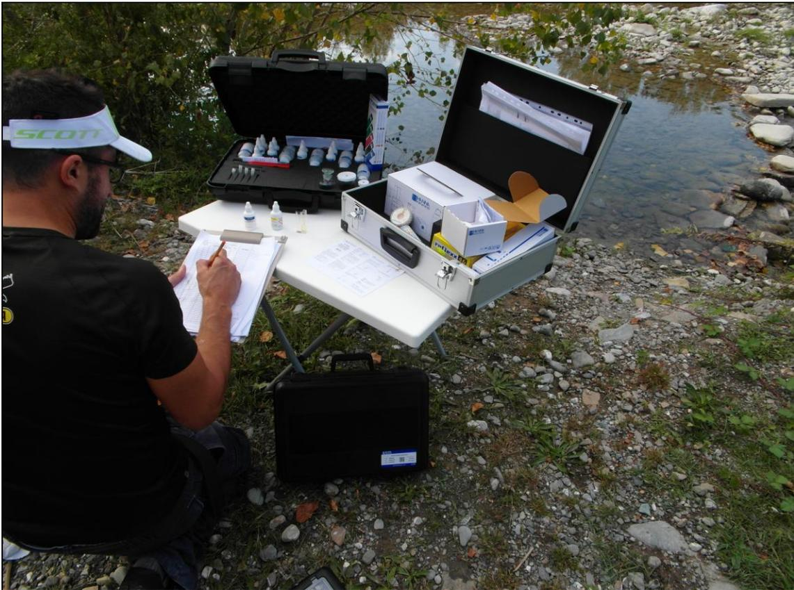
**Figura 1e: rilevamento dei principali parametri chimico-fisici dell'acqua**
