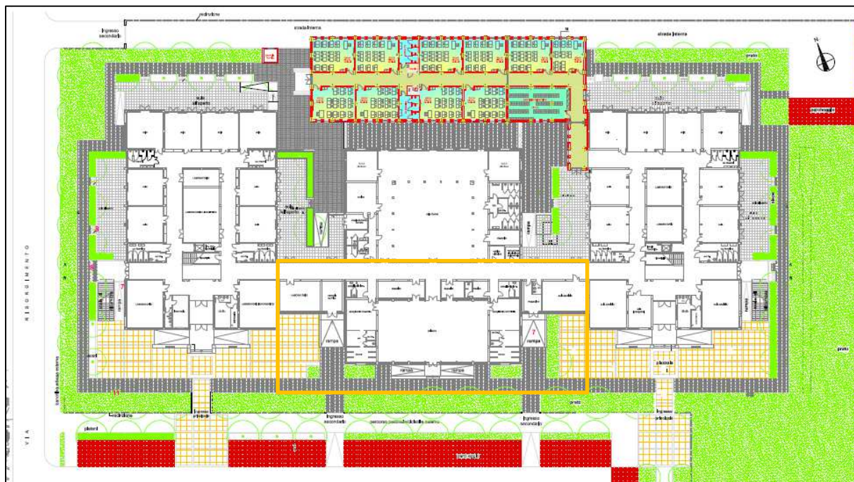
Figura 4 – Tavola con la planimetria di massima del progetto di ampliamento del polo: il rettangolo arancione individua l'estensione occupata dall'ampliamento in relazione con gli edifici esistenti.
