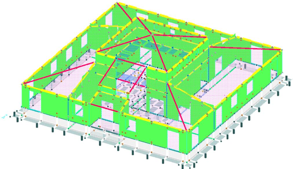
Verifica delle murature di progetto: taglio allo  $SLU+(S_x, S_y)*0.60$
