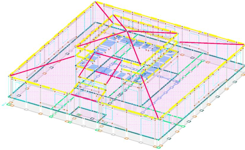
Schema strutturale 3D agli elementi finiti con ingombri:
