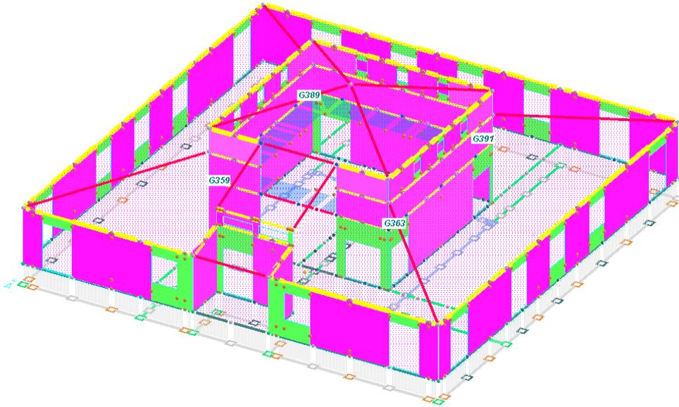
Verifica delle murature nello stato di fatto: pressoflessione ortogonale nel piano allo  $SLU+(S_x, S_y)*0.60$
