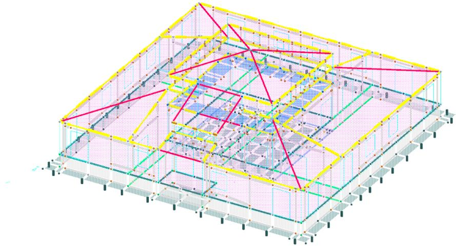
Schema strutturale 3D agli elementi finiti con ingombri:
