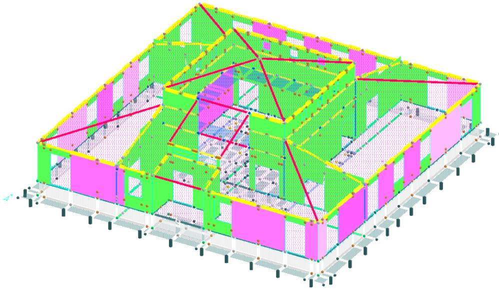
**Verifica delle murature di progetto: pressoflessione ortogonale al piano allo  $SLU+(S_x, S_y)*0.60$**
