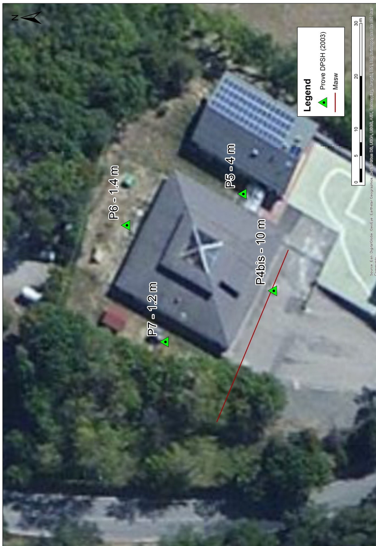
Fig. 4.1 – dettaglio ubicazioni indagini. Le etichette dei singoli punti (prove DPSH) mostrano il codice identificativo della prova e la profondità di ritrovamento del bedrock per la suddetta prova.
