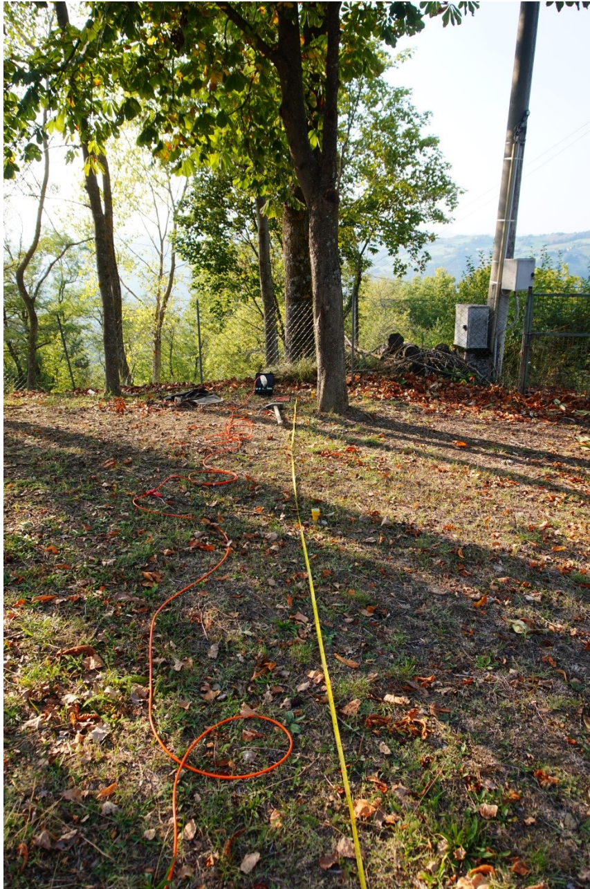
Fig. 4.2 – Foto rappresentante lo stendimento di geofoni per l'indagine sismica a onde di superficie MASW (PARK et al., 1999).
