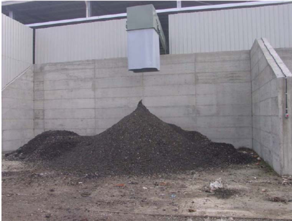
Figura 9 – Frazione fine separata nell'intervento di LFM della discarica di Modena
