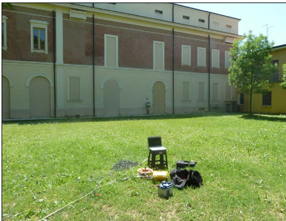
Fig. 4.2.2.2: Immagine rappresentativa dello stendimento sismico MASW n. 1.
