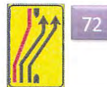
Figura II 413/c Art. 43 SEGNALE DI RIENTRO IN CARREGGIATA
